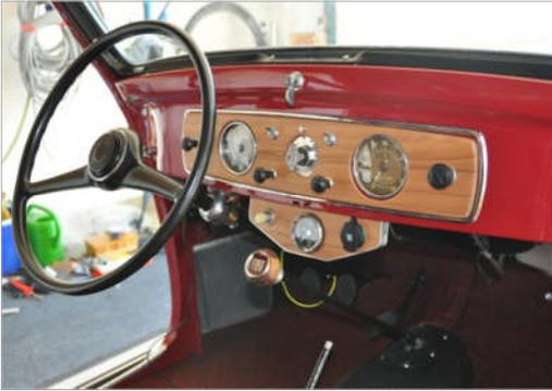
Eine kleine Abweichung vom Original sind die Temperaturanzeige, die Blinker, der Schaltknäuf aus Holz mit dem FIAT-Logo, sowie eine 12-V Steckdose im Zigarettenanzünderformat.
