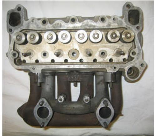
*Topi C Zylinderkopf mit Doppelvergaserflansch von Weber*
