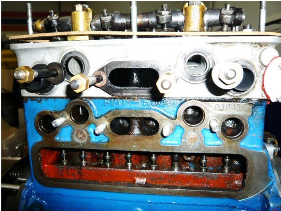
*Topi A Motor mit Testa-d'Oro-Zylinderkopf*
