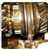
c.) **Blick** ins Topo - Getriebe beim Schalten des 3. Gang
