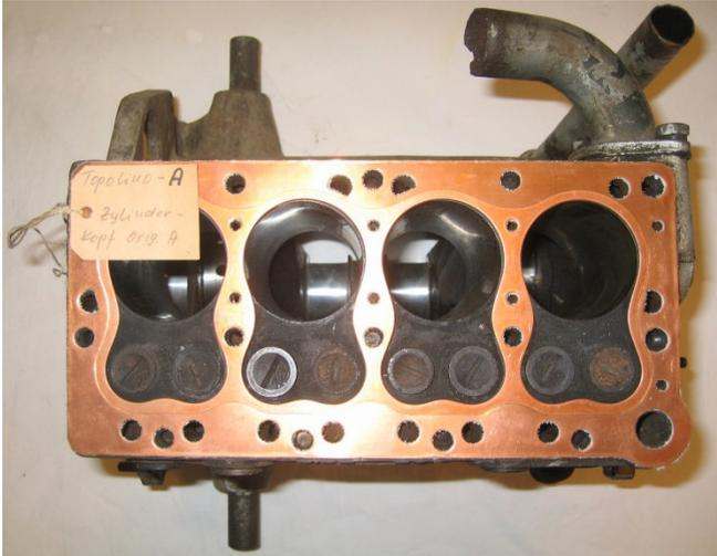
*Topi A Motorblock mit Zylinderkopfdichtung*
