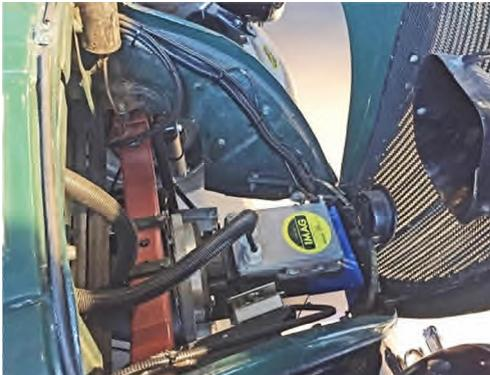
Der Elektromotor ist auf dem Chassis befestigt und mit einem Passstück mit dem Getriebe verschraubt. Wie der Elektromotor die Kraft an das Getriebe weitergibt ist nicht sichtbar. Anzunehmen ist, dass dies mit einer
