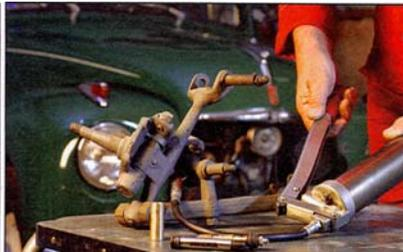
Der Topolino hat viele **Schmiernippel**, speziell an der Vorderradaufhängung, die alle regelmäßig mit Fett zu versorgen sind
