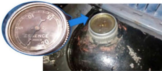
Tankverschluss mit Benzinstandanzeige: Zubehör SIMCA cinq
