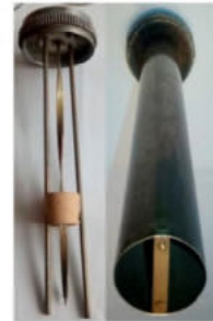
Tankverschluss mit Benzinstandanzeige: Zubehör SIMCA cinq
