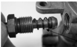
Starterventil am Weber-Vergaser 22 DRS
