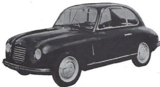
Mit gerundeter Frontscheibe und feststehenden runden Seitenscheiben aus Plexiglas, der Fiat Zagato 500 Panoramica von 1947.
