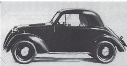
Der Wasserkühler saß hinter dem Vierzylinder-Motor, die Kurbelwelle war zweifach gelagert. Fiat 500 A.
