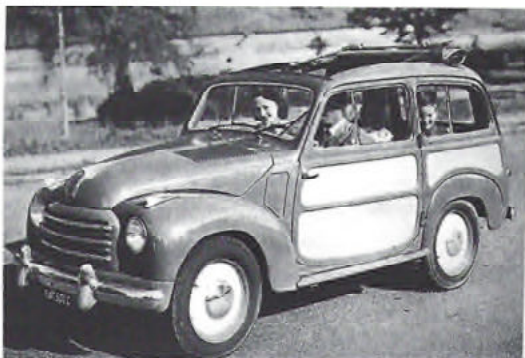
Die Kombiversion gab es ab 1949 mit hinterem Holzaufbau als Giardiniera und ab 1951 mit hinterem Stahlaufbau als Belvedere.
