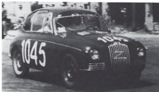
Senkrechte Chromstreifen am Kühlergrill und auf 750 ccm vergrößertem Vierzylinder, der Zagato 750.
