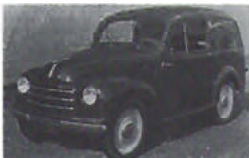
Die deutsche Karosseriefabrik Weinsberg baute als Einzelstücke 1950 den Fiat 500 C als Kombi- und als Lieferwagen mit hinterem Stahlaufbau.
