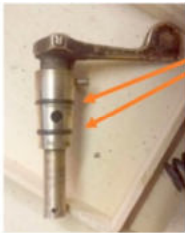
Eingedrehte Nuten mit passenden O-Ringen
