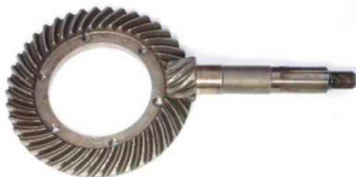
1. Teller- und Kegelrad für Achsgetriebe mit Aluminium-Gehäuse, bis Baujahr 1950: bis Fg.Nr. 279488 / 282399/ 286603 * Das zweiteilige Alugehäuse wurde von 1936 bis 1950 mit kleinen Änderungen eingebaut
