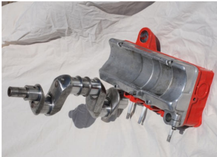
Kurbelwelle, Brandoli- Zylinderkopf und Brandoli- Ventildeckel mit Lichtmaschinen- aufnahme
