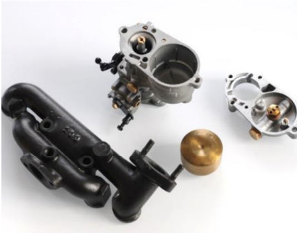
30 mm Solex- Fallstromvergaser und Surva- Kollektor (Krümmer)
