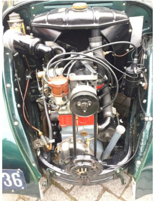
Brandoli-Motor im Topolino A eingebaut
