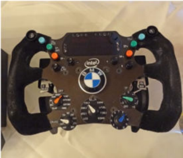
Dieses Lenkrad ist mit einem Bordcomputer ausgestattet
