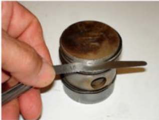
Spiel des Kolbenrings in der Ringnut prüfen: Neuzustand 0,04 bis 0,06mm/ Verschleißgrenze 0,15mm
