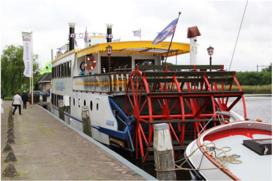
Ein für uns ungewohnter Anblick: Der Heckradantrieb
