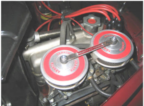
Doppelvergaseranlage Weber mit Abarth-Luftfiltern im Topi C eingebaut
