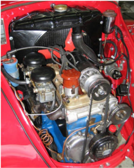
Testa-d'Oro mit Doppelvergaser, Benzin- und Wasserpumpe eingebaut im Topi Weinsberg
