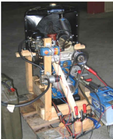
Motorenprüfstand für Testa-d'Oro – Profis: Bitte wegschauen...
