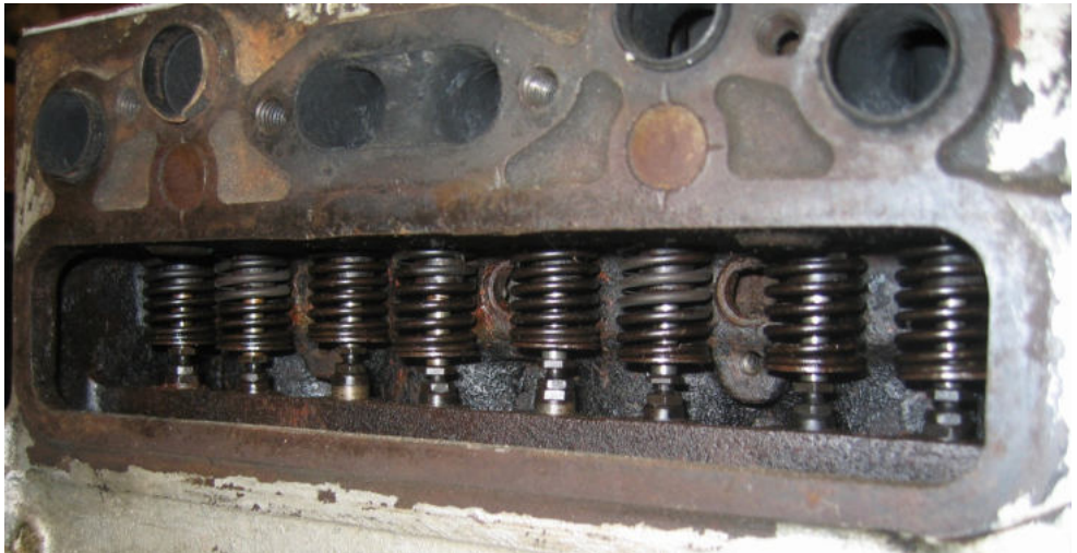
Blick auf die seitengesteuerten Ventile beim Topi A Motor
