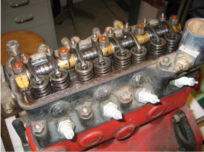
Topi A Motor mit Siata-Kopf und hängenden Ventilen – Ventilfeuern mit doppelten Ventilfeuern
