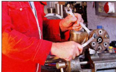
Besonderes Augenmerk verdient die Hardyscheibe . Wenn diese reißt, kann die Kardanwelle größere Schäden verursachen
