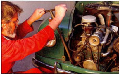
Zum Ölwechsel gehört das Reinigen des Ölfilters . Artur Ambros löst den schlecht zugänglichen Filter mit einem Spezialschlüssel
