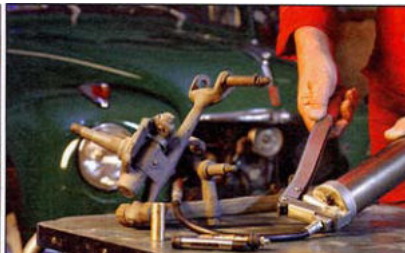
Der Topolino hat viele Schmiernippel , speziell an der Vorderadaufhängung, die alle regelmäßig mit Fett zu versorgen sind
