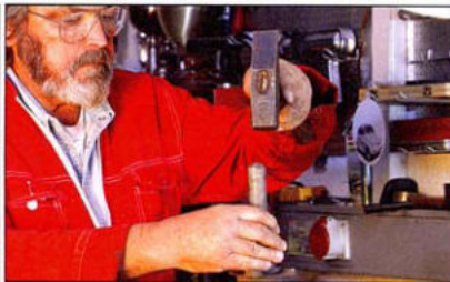
Vor allem die lange Kardanwelle des Topolino verdient erhöhte Aufmerksamkeit. Zur Überholung gehören neue Führungsbuchsen
